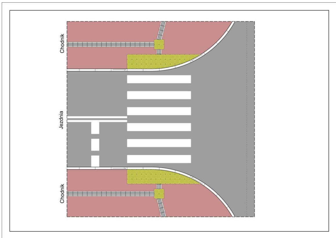
Rysunek 26. Schemat oznakowania przejścia dla pieszych zlokalizowanego na łuku
