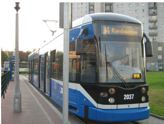
Fot. 5-10. Tabor niskopodłogowy – szerokie wejścia do autobusu i tramwaju umożliwiające wjazd wózka inwalidzkiego, oznaczenia i przyciski.
