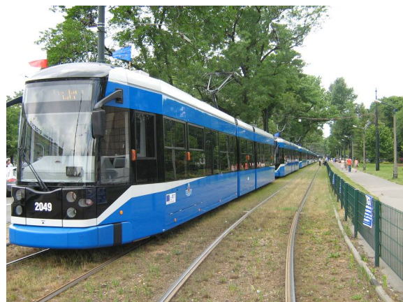
Fot. 5-10. Tabor niskopodłogowy – szerokie wejścia do autobusu i tramwaju umożliwiające wjazd wózka inwalidzkiego, oznaczenia i przyciski.
