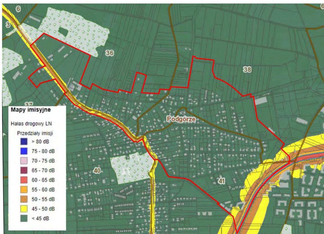
Ryc. 17 Wyrzys z Mapy akustycznej Krakowa – mapa emisji dla hałasu drogowego L N .
