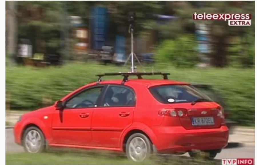
Imersyjny system mobilny zawierający zaawansowane systemy: nawigacyjny, inercyjny i wizyjny
