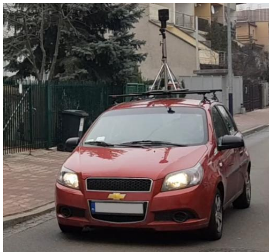
Rysunek 2 Imersyjny system mobilny umieszczony na dachu samochodu.
