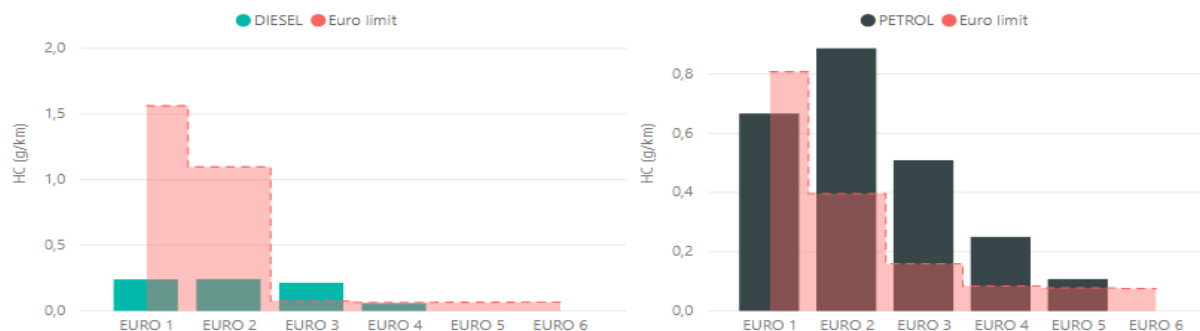
Rysunek 10-6 Średnia emisja HC (g/km) lekkich pojazdów dostawczych (LDV) pogrupowana według rodzaju zasilania paliwem oraz norm Euro vs. limity norm Euro.
