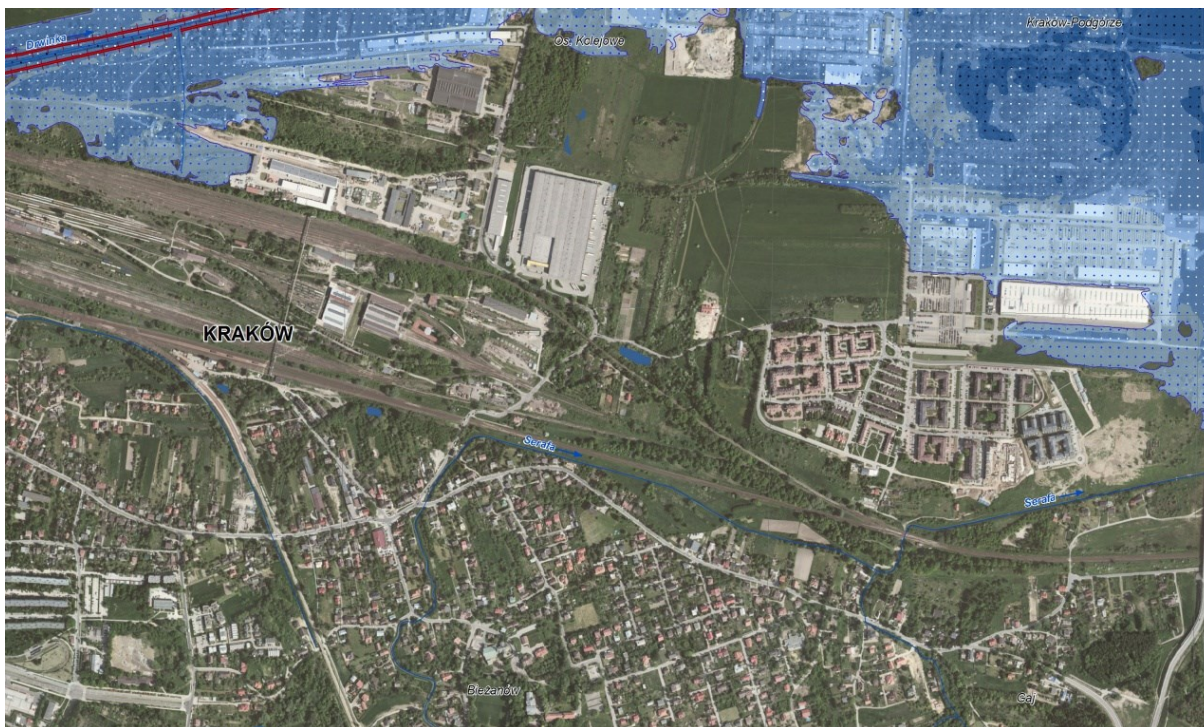
Rys.1. Całkowite zniszczenie wału przeciwpowodziowego - mapa zagrożenia powodziowego wraz z głębokością wody - całkowite zniszczenie wału przeciwpowodziowego, prawdopodobieństwo wystąpienia powodzi 1% - raz na 100 lat
