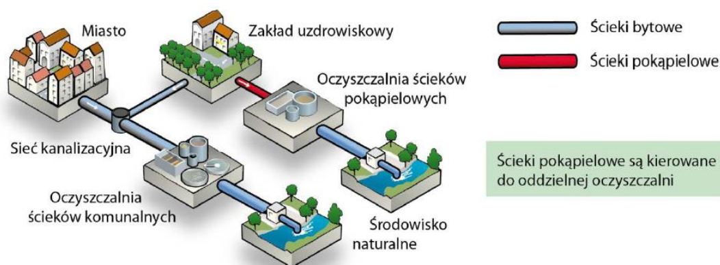
Rys.5.1. Ideogram prawidłowej gospodarki ściekowej uzdrawiska
