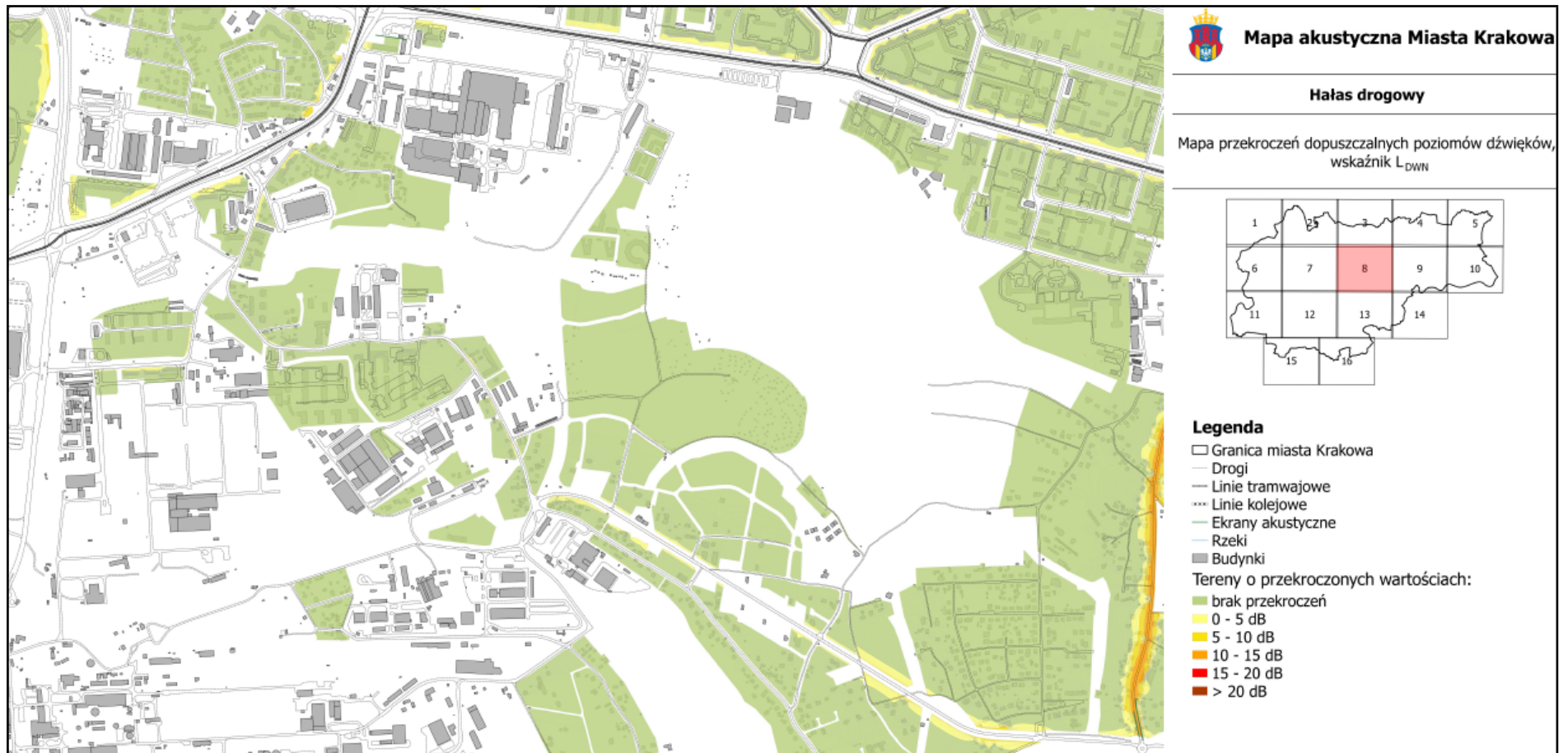
Rys. 5.1. Wycinek mapy przekroczeń poziomu hałasu pochodzącego od ruchu samochodowego na terenie Miasta Krakowa - wskaźnik L_{DWN}
